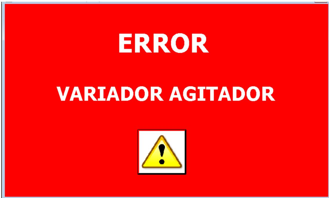
Error variador agitador, aparece cuando hay un fallo en el motor del agitador puede ser generado por una sobrecarga a la maquina un producto muy pastoso o demasiado denso para ser movido por las palas de la máquina,
