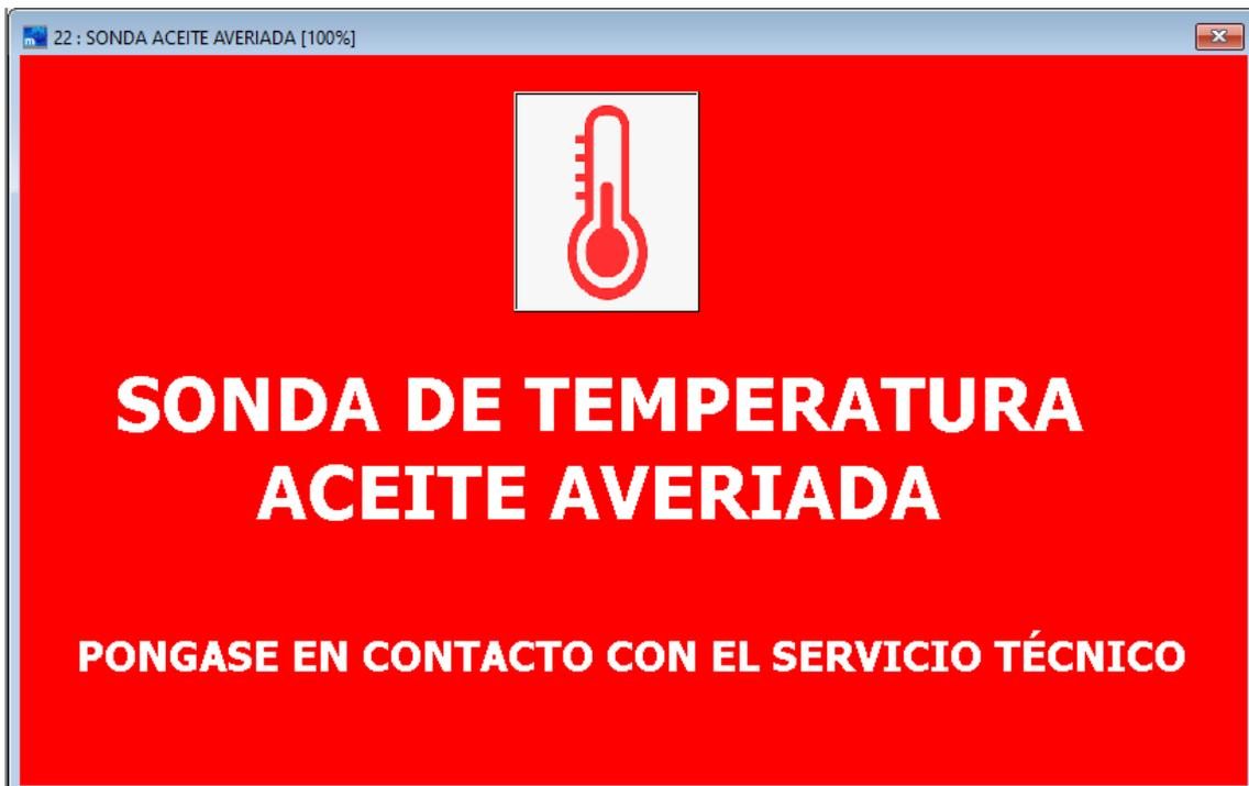
Este mensaje aparece cuando la sonda que mide la temperatura del aceite térmico ha fallado o esta averiada, es importante tomar medidas de corrección ya que se considera un fallo grave el cual para completamente el funcionamiento de la máquina.
