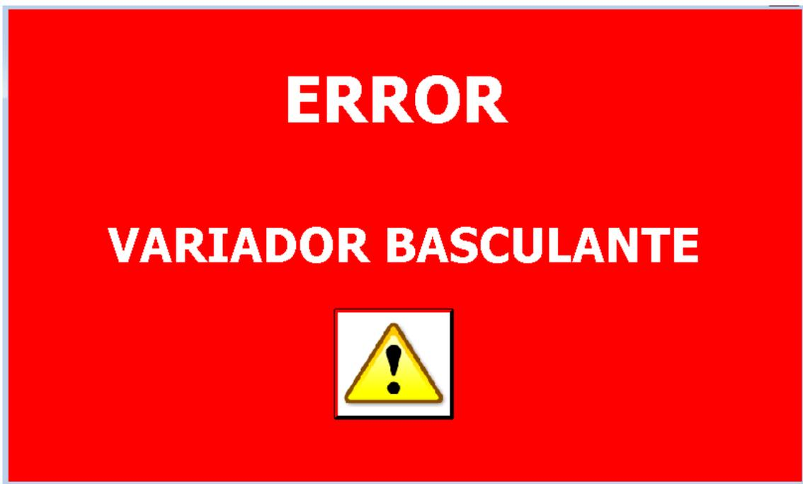
Error variador basculante, aparece cuando hay un fallo en el motor del basculante puede ser generado por una sobrecarga (demasiado peso o bloqueo mecánico) a la máquina.
