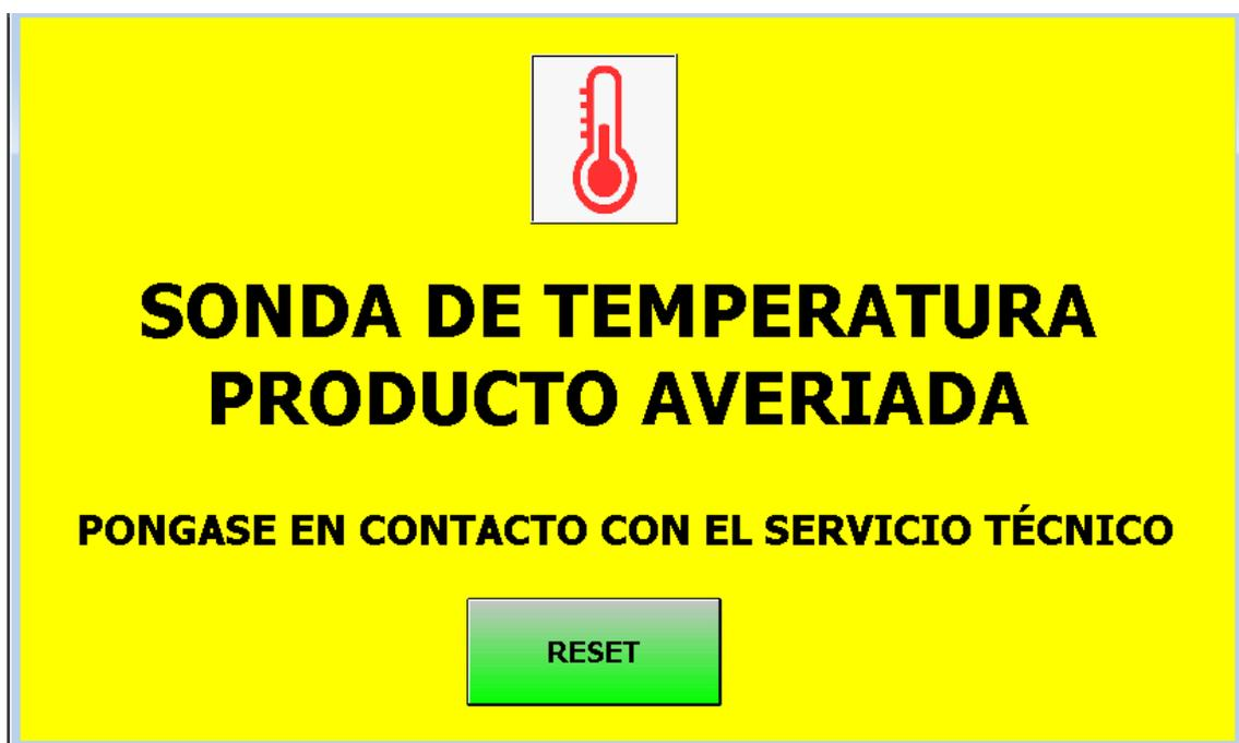
Este mensaje indica que hay una sonda averiada pero no para para máquina ya que la temperatura que muestra esta sonda es de carácter orientativo no actúa directamente en el proceso.
