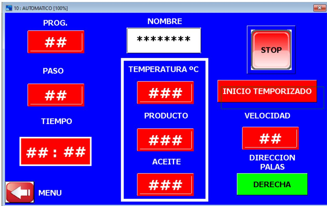
Figura 3. Pantalla del modo automático
