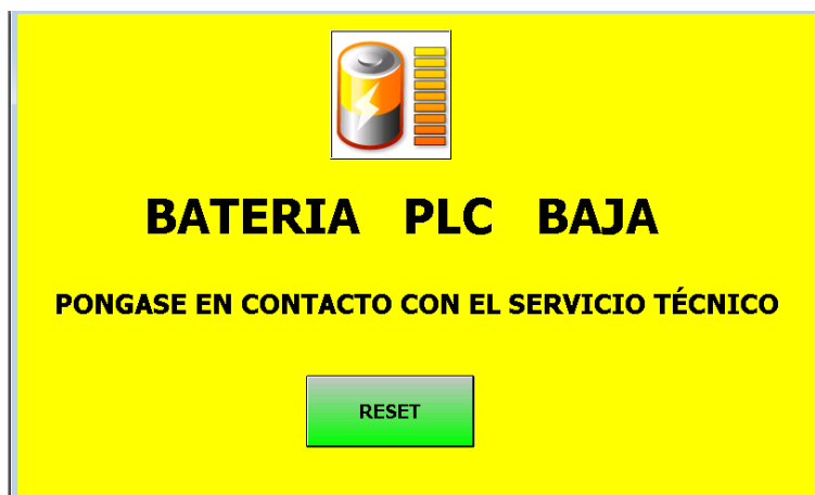
Figura 12. Pantalla batería PLC
