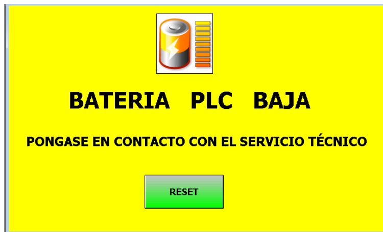
Figura 12. Pantalla batería PLC
